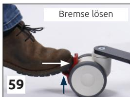
Die Bremsen der **SLK Multy Patientenlifter** befinden sich **an den hinteren Rollen**. Betätigen Sie **immer beide Bremsen**, um den Lifter zu bremsen.
