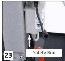
Diese **Sicherheitsschaltung** verhindert, dass der **SLK Multy** betrieben wird, obwohl der Standmast nicht korrekt mit dem Bolzen gesichert ist.
