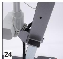
**Fehlt** der Bolzen (Abb. 24) oder ist er **nicht bis zum Anschlag eingebaut** (Abb. 25), sind die elektrischen Hebefunktionen **gesperrt**. Das gilt für **alle drei Positionen** des Standmastes.
