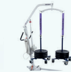
aufgehängter Zustand (Test bei einem 185 kg Lifter)
