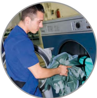
Die Anlage ist konsequent in eine reine und eine unreine Seite getrennt. Stark verschmutzte Bestandteile (beispielsweise Bezüge und Transporttaschen) werden in speziellen Waschmaschinen gereinigt, während Luftkammern und Unterbauten in einer automatisierten Wasch- und Desinfektionsstraße aufbereitet werden. Dieses Verfahren gewährleistet minimale mechanische Belastung bei maximaler hygienischer Wirksamkeit.
