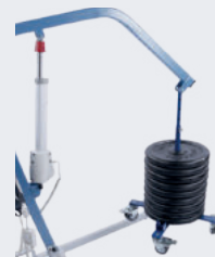
aufgehängter Zustand mit Last
