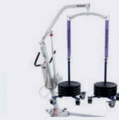
aufgehängter Zustand (Test bei einem 185 kg Lifter)
