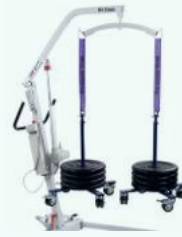
aufgehängter Zustand (Test bei einem 185 kg Lifter)
