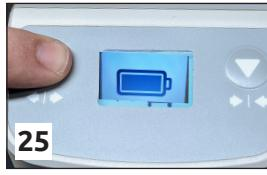
Durch **längeres Drücken** (> 0,5 Sek.) der **Taste A oder B** im Menüpunkt "Hebeamr" (Abb. 24) wird der **Motor bewegt**.
