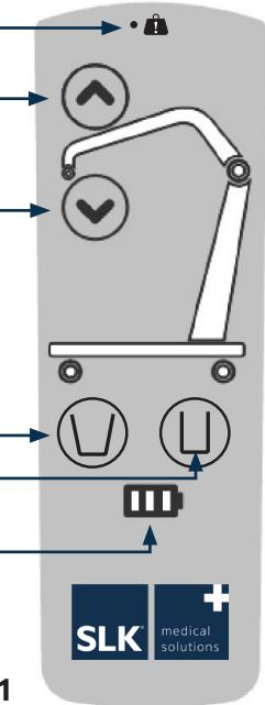
Die **SLK Eazy-up Aktivlifter** lassen sich auch über die Steuerbox im Tippbetrieb bedienen. Ihr Lifter ist mit **Steuerbox Typ I (Abb. 22)** oder **Typ II (Abb. 23)** ausgestattet. Vergleichen Sie die Abbildungen mit Ihrem Lifter um die passende Anleitung zu finden.
